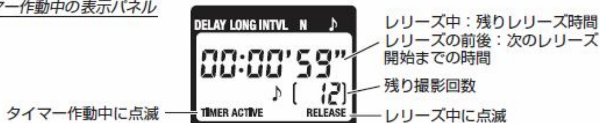
タイマー作動中の表示パネル
