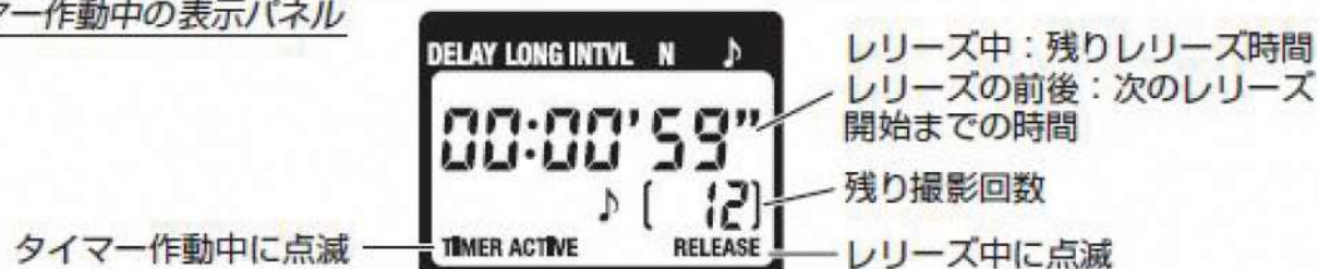
タイマー作動中の表示パネル
